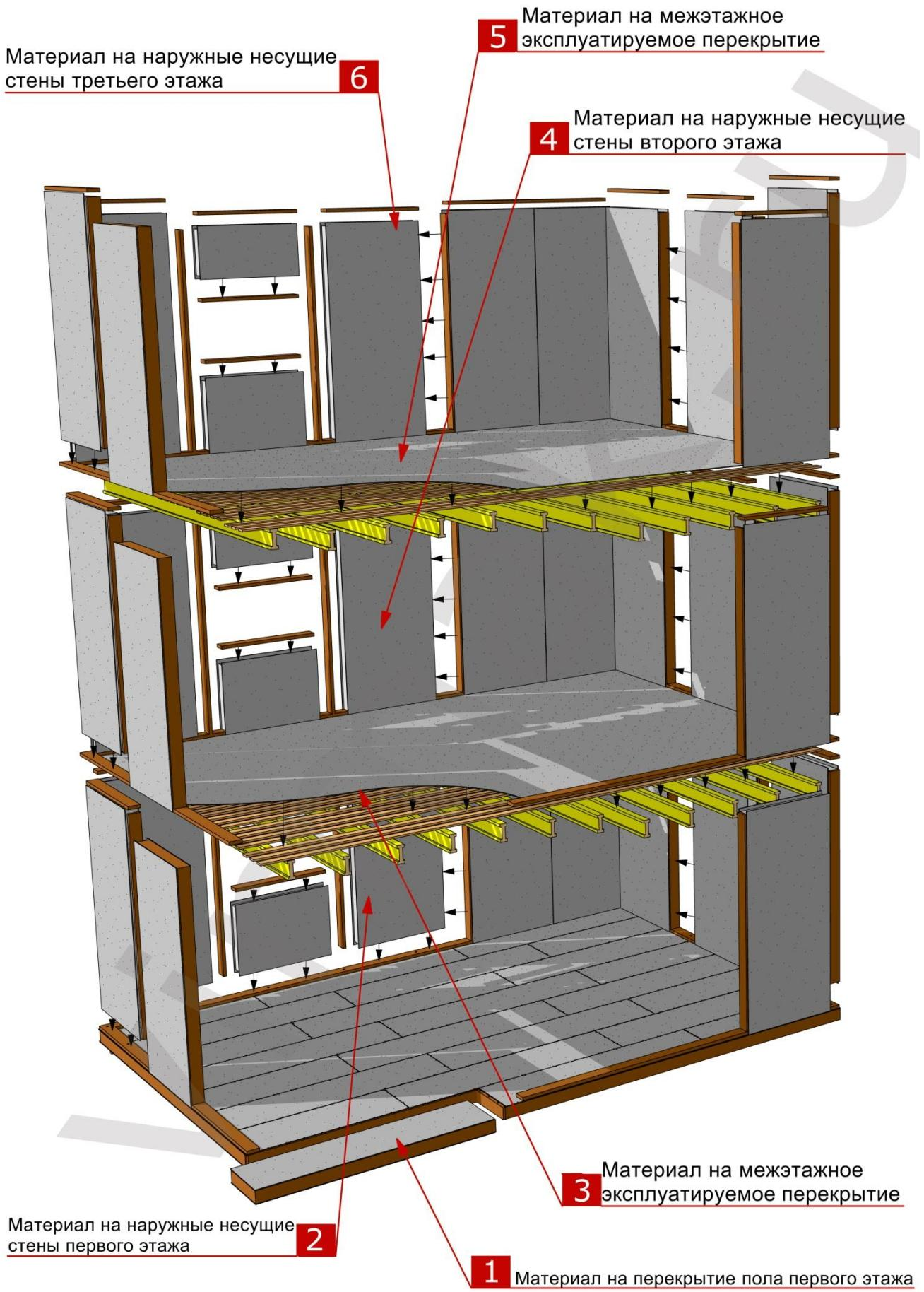
Инструкция по сборке + карта сборки; раскрой СИП панелей (распил СИП панелей согласно карты раскроя); устройство выемки (паза) в СИП панелях; зенкование в СИП панелях ЦСП листов обрусовка СИП панелей.
